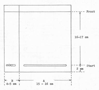
Abb. 2. Schema für Dünnschichtchromatographie
