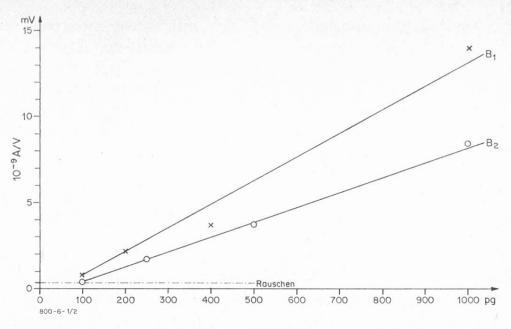
Abb. 3. Massenfragmentographie: Abhängigkeit der Intensität des Molekülionenpeaks der Aflatoxine B von der Probemenge (3100 D, PROMIM, EI 70 eV/1,5 mA, 10<sup>-9</sup> A/V)
