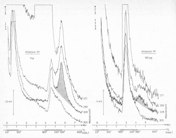
Abb. 2. Massenfragmentographie von Aflatoxin M<sub>1</sub>: Durch optimiertes Aufheizen gelingt die Abtrennung der Massenpeaks von der druckabhängigen Nullinienschwankung durch Desorption von Wasser auf den beheizten Oberflächen. Eine Erniedrigung der Nachweisgrenze wird dadurch erreicht (3100 D, PROMIM, EI 70 eV/1,5 mA, 10<sup>-9</sup> A/V)
