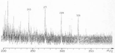
Abb. 4 oben Massenspektrum einer HPLC-Fraktion: mit Aflatoxin natürlich kontaminiertes Milchpulver, 3 Jahre gelagert (3100 D, Probe ca. 200 °C)
