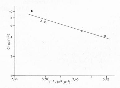
Abb. 1. Einfluß der Lufttemperatur auf die PCP-Konzentration in der Luft Meßwert vom 31.5.1978, OMeßwerte vom 16.11.—22.11.1978, Schlafraum Familie 19, Fenster und Türe geschlossen
