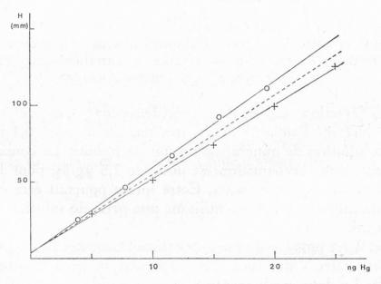
Fig. 4. Etalonnage par réduction de Hg<sup>++</sup> (+) et par injection d'air saturé de vapeur de Hg<sup>o</sup> (o) (1 ml d'air saturé à 25,0 °C et 760 Torr contient 19,38 ng Hg (15)). H est la hauteur des pics d'absorption en mm. Les droites de régression correspondantes sont représentées en trait continu et la relation corrigée pour la pression atmosphérique en trait discontinu
