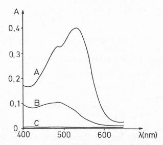
Fig. 4. Absorptionsspektren der Eluate (Küvette 1 cm, OG)
