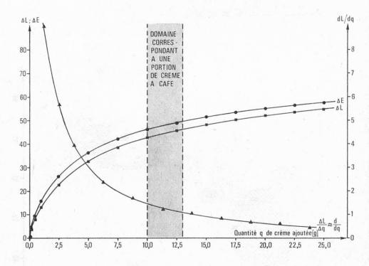
Fig. 5. Variations des grandeurs ΔL, ΔE et ΔL/Δq ou dL/dq (cf. définitions dans le texte) d'un café soluble donné, de volume total constant, en fonction de la quantité q de crème à café ajoutée (étalonnage avec le standard jaune)
