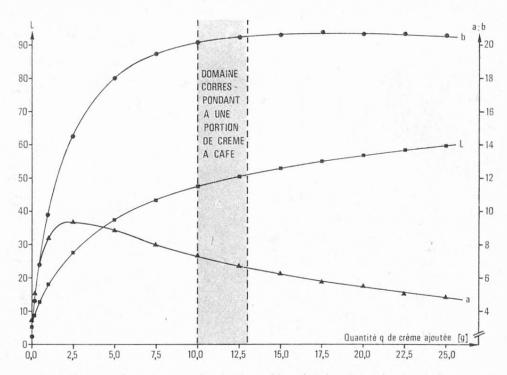
Fig. 4. Variation des couleurs L, a, b d'un café soluble donné, de volume total constant, en fonction de la quantité q de crème à café ajoutée (étalonnage avec le standard jaune)
