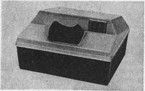
Transparente Dunkelkammer mit umschaltbaren UV-Lichtquellen für kurz- oder langwelligen Betrieb. Besonders gut geeignet um schwach fluoreszierende Proben zu untersuchen.
