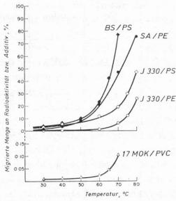
Abb. 4. Auswanderung von markierten Additiven in Fettsimulans HB 307 innerhalb von 10 Tagen zwischen 30° und 80°C
