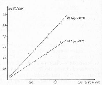
Abb. 9. Auswanderung von VC in HB 307 in Abhängigkeit von der VC-Konzentration im PVC
