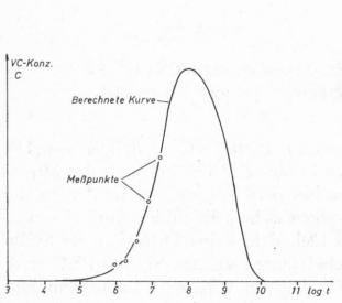
Abb. 8. VC-Auswanderung aus PVC in Testfett HB 307 in Abhängigkeit von der Kontaktzeit
