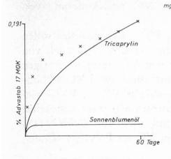
Abb. 6. Diffusion des Organozinn-Stabilisators Advastab 17 MOK aus PVC in Tricaprylin und Sonnen-blumenöl
