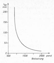
Abb. 3. Spannungsrißkorrosion von Polystyrol. Kontaktmedium: homogenisierte Sahne. Abhängigkeit der t<sub>50</sub>-Werte von der Spannung
