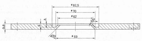
A = épaisseur du disque de verre + épaisseur du joint de téflon
