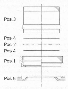
Fig. 2. Assemblage des éléments de la cellule (en coupe); échelle env. 1:3
