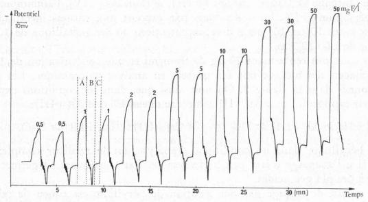
Fig. 9. Cinétique de réponse de l'électrode
