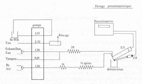
Fig. 3. Manifold pour la méthode potentiométrique. ES: Électrode sélective. ER: Électrode de référence Ag/AgCl. Pour les autres symboles voir figure 2.
