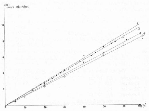
Fig. 5. Courbes d'étalonnages de solutions concentrées 1 et 2 courbes en milieu acqueux à 3 jours d'intervalle 3 et 4 courbes analogues à 1 et 2 en présence de silicate de sodium 1 g/l
