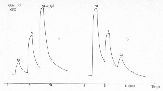
Fig. 7. Cinétiques de la réponse de l'électrode
