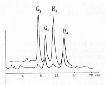
Abb. 1. Auftrennung eines Aflatoxin-Standardgemisches auf μ-Bondapak-C<sub>18</sub> Mobile Phase: H<sub>2</sub>O-CH<sub>3</sub>OH (56:44 v/v), 1,6 ml/min je 40 ng AF B<sub>1</sub> und G<sub>1</sub>, je 8 ng AF B<sub>2</sub> und G<sub>2</sub>
