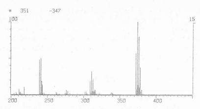
Abb. 5. Massenspektrum No. 351 (m/e 200—450) für ein Hexa-CDF.  $M^+$  = 372,  $Cl_6$ ;  $M^+$ —COCl = 309,  $Cl_5$ ;  $M^+$ — $COCl_2$  = 239,  $Cl_3$ .
