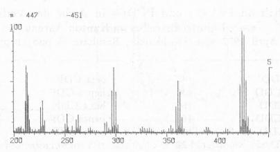
Abb. 4. Massenspektrum No. 447 (m/e 200—450) für ein Hepta-CDD.  $M^+ = 422$ ,  $Cl_7$ ;  $M^+ - COCl = 359$ ,  $Cl_6$ ;  $M^+ - 2$  COCl = 296,  $Cl_5$ ;  $M^2 + = 211$  usw.
