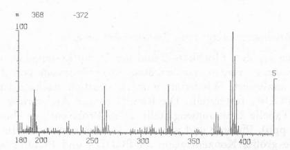
Abb. 3. Massenspektrum No. 368 (m/e 180—430) für ein Hexa-CDD.  $M^+=388$ ,  $Cl_6$ ;  $M^+$ —COCl=325,  $Cl_5$ ;  $M^+$ —COCl=262,  $Cl_4$ ;  $M^2+=194$  usw. Das Spektrum zeigt ein gleichzeitig eluierendes Hexa-CDF ( $M^+=372$ ) an.
