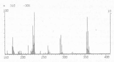
Abb. 2. Massenspektrum No. 310 (m/e 160—410) für ein Penta-CDD.  $M^+ = 354$ ,  $Cl_5$ ;  $M^+ - COCl = 291$ ,  $Cl_4$ ;  $M^{2+} = 177$  usw.
