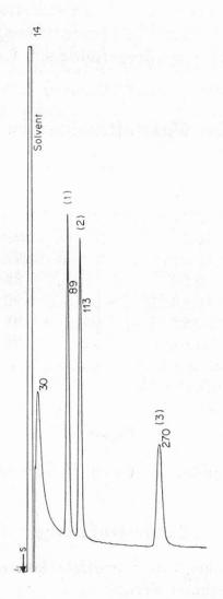
Abb. 1. GC-Trennung der Keimhemmungsmittel auf der OV-17 Säule, Detektor Thermoionic ((AFID)
