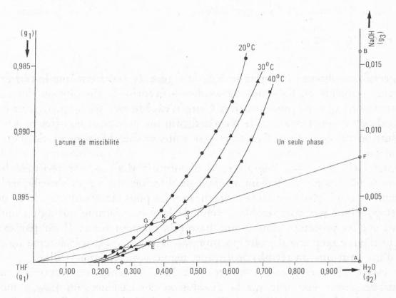
Fig. 1. Diagramme de solubilité du système eau — hydroxyde de sodium — tétrahydrofurane: domaine intéressant la dissolution du lait (isothermes de 20°C, de 30°C et de 40°C)
