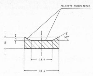
Abb. 1. Teflongefäß zum Eindampfen der Eluate
