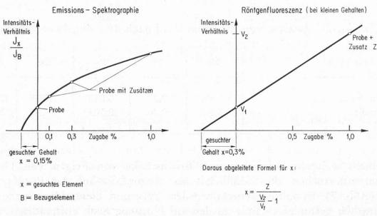
Abb. 5. Die Additionsmethode in der Emissions- und Röntgenspektralanalyse
