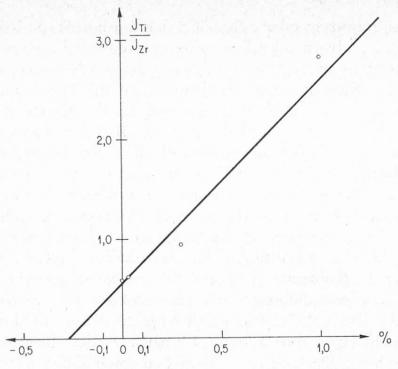
Abb. 6. Eichkurve für Titan in Zirconiumoxid
