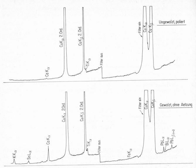
Abb. 2. Spektren einer gewalzten und einer ungewalzten Kupferprobe
