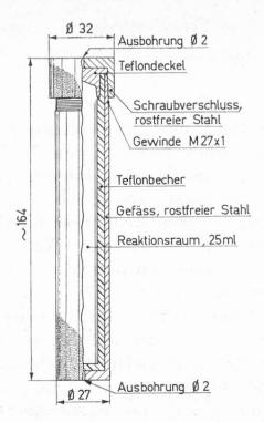
Abb. 1. Hochdruck-Aufschlußtopf (Angaben in mm)
