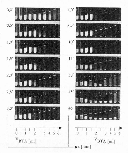
Figure 6. Aspect de la dissolution d'un lait entier (1 ml) dans un mélange de NaOH 0,2 mol/l (1 ml) et de n-butylamine pure ( $V_{\rm BTA}$  en ml), en fonction du temps de chauffage t (en min) à 60°C.
