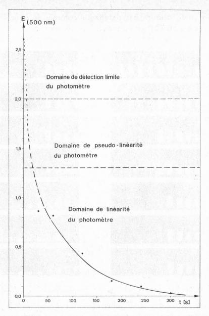
Figure 5. Influence de la durée t du chauffage (à T = 60°C) sur la dissolution d'un lait entier
