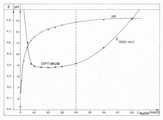
Figure 2. Influence de la concentration de la soude caustique sur la dissolution d'un lait écrémé
