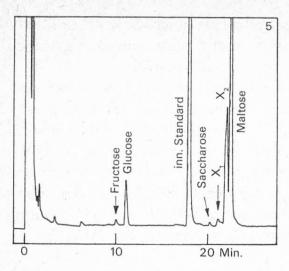
Abb. 5. Maltose hydrolysiert nach Zollvorschrift. GC der Zucker-oximsilylderivate.
