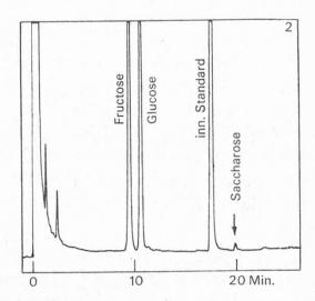
Abb. 2. Saccharose hydrolysiert nach Zollvorschrift. Lösung vor dem Eindampfen genau auf pH = 7,0 gestellt. GC der Zucker-oxim-silylderiyate.
