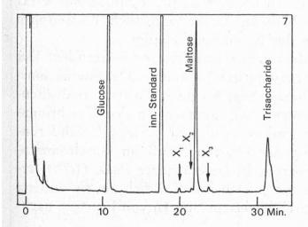
Abb. 7. Glucosesirup vor Hydrolyse. GC der Zucker-oxim-silylderivate.
