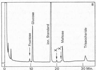
Abb. 8. Glucosesirup hydrolysiert nach Zollvorschrift. GC der Zucker-oxim-silylderivate.
