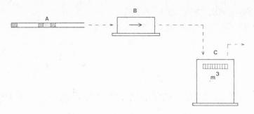
Fig. 1. Dispositif de prélèvement. A = tube d'absorption. B = pompe à membrane. C = compteur à gaz.
