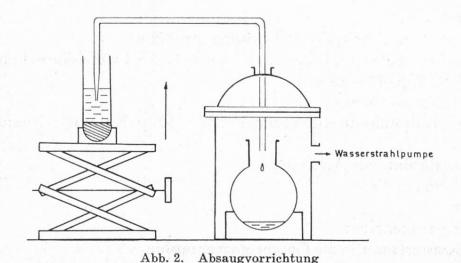
Nach einmaliger Extraktion werden 90% und mehr der Fettbestandteile und Emulgatoren extrahiert. Die Toluol-Lösung wird im Wasserbad (40—50°C) am Rotationsverdampfer unter Vakuum (Wasserstrahlpumpe) auf wenige ml eingeengt. Der zurückbleibende Extrakt (A) wird verseift.
