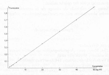
Fig. 4. Dosage spectrofluorimétrique de la coumarine; droite d'étalonnage I  $_{\rm Fluorescence} = f({\rm concentration})$   $\lambda_{\rm exc}$  365 nm  $\lambda_{\rm anal}$  495 nm; sensibilité 8×1, solution Ethanol 80%, NaOH N/10.
