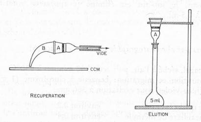
Fig. 1. Dispositif de récupération et élution des spots de chromatographie sur couche mince.
