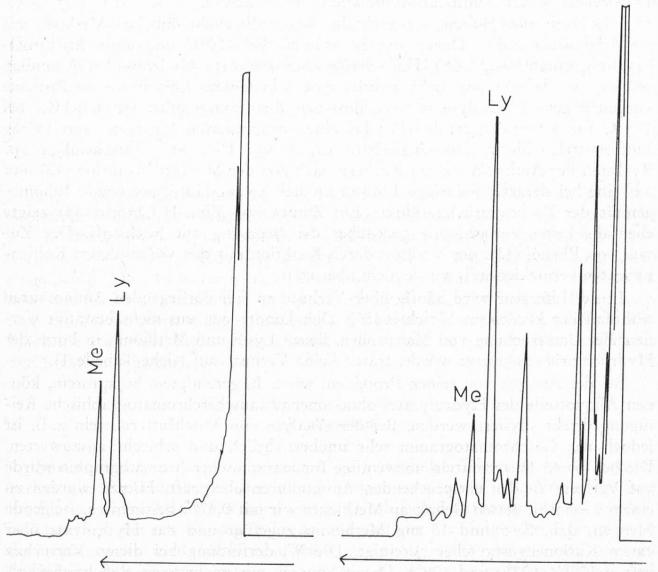
Abb. 1. Gaschromatogramm einer Lysin- und Methionineichlösung.
