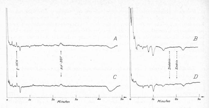
Abb. 1. Gaschromatogramme von an Porasil A bzw. nach der AOAC-Methode gereinigtem Sonnen-blumenöl (Resultate vgl. Tabelle 4). AOAC-Methode: je 3  $\mu$ l dosiert, entspricht 0,92 mg Oel; Chromatogramm A entspricht dem 6% Aether-Petroläther und Chromatogramm B dem 15% Aether-Petroläther-Florisileluat. Porasil A: je 3  $\mu$ l eingespritzt, entspricht 0,75 mg Oel; Chromatogramm C entspricht dem Eluat von 0—6 ml und Chromatogramm D dem Eluat von 6—10 ml. GC-Bedingungen: ECD, Kolonne OV-210, 185°C.
