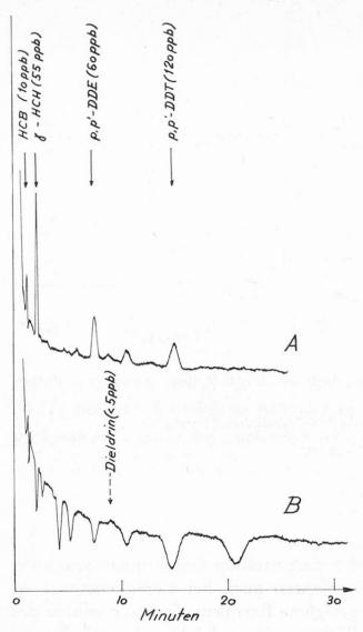
Abb. 4. Gaschromatogramme eines an Porasil A gereinigten **Weizenextraktes** (Herstellung vgl. Text), eingespritzte Menge je 2  $\mu$ l, entspricht 0,2 mg Weizen. Chromatogramm A 0—7,5 ml Eluat, Chromatogramm B 7,5—13 ml Eluat. GC-Bedingungen: ECD, OV-17/QF-1-Mischkolonne (Phasenverhältnis = 1,33), 180°C.
