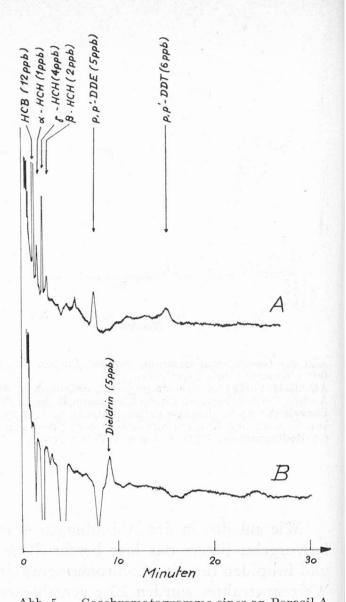
Abb. 5. Gaschromatogramme eines an Porasil A gereinigten **Eiextraktes** (Herstellung vgl. Text), eingespritzte Menge je 2 µl, entspricht 2,3 mg Vollei. Chromatogramm **A** 0—7,5 ml Eluat, Chromatogramm **B** 7,5—13 ml Eluat. GC-Bedingungen: ECD, OV-17/QF-1-Mischkolonne (Phasenverhältnis = 1,33), 180°C.
