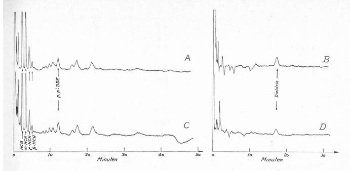
Abb. 3. Gaschromatogramme von an Porasil A bzw. nach der AOAC-Methode gereinigtem Butterfett (Resultate vgl. Tabelle 4).
