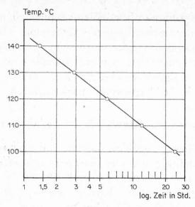
Abb. 1. Temperaturabhängigkeit der Induktionszeit.
