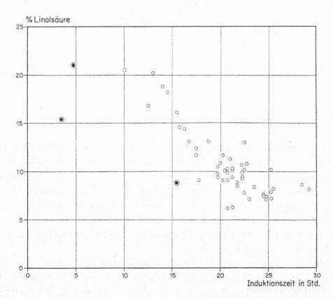
Abb. 2. Beziehung zwischen Linolsäuregehalt und Induktionszeit.
