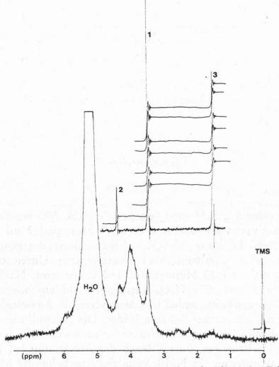
Abb. 1. <sup>1</sup>H-NMR Spektren von Melasse vor (unten) und nach (oben) der Behandlung mit konz. H<sub>2</sub>SO<sub>4</sub> und 30<sup>0</sup>/<sub>0</sub> H<sub>2</sub>O<sub>2</sub> (1:CH<sub>3</sub>-Protonen von Betain, 2:CH<sub>2</sub>Protonen von Betain, 3:CH<sub>3</sub>-Protonen von tert.-Butylammonium).
