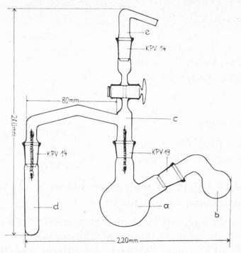
Abb. 1. Mikro-Vakuum-Destillationsapparatur nach Burg-Mook
