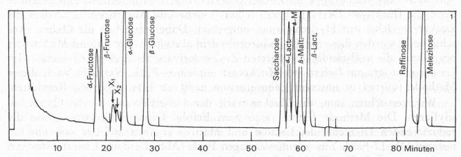
Abb. 1. GC der Zucker-silyläther einer Modellmischung. Stahlsäule 2,5 m  $\times$   $^{1/8}$ ",  $^{50/0}$  OV-17. Temperaturprogramm:  $110^{\circ}\text{C} + 2^{\circ}/\text{Min.} \rightarrow 275^{\circ}\text{C}$ .
