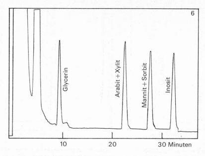
Abb. 6. GC der Silyläther von Glycerin und Zuckeralkoholen. Temperaturprogramm:  $80^{\circ}\text{C} + 4^{\circ}\text{/Min.} \rightarrow 275^{\circ}\text{C}$ .
