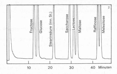
Abb. 2. GC der Zucker-oxim-silylderivate (Stearinsäure als inneren Standard)
