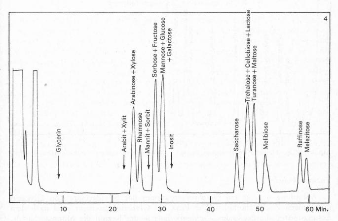
Abb. 4. GC der Zucker-oxim-silylderivate von 17 verschiedenen Zuckerarten. Temperaturprogramm:  $80^{\circ}\text{C} + 4^{\circ}/\text{Min.} \rightarrow 275^{\circ}\text{C}$ .
