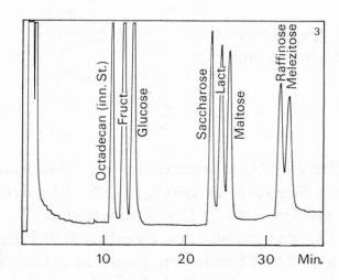
Abb. 3. GC der Zucker-oxim-silylderivate (Octadecan als innerer Standard) Temperaturprogramm:  $130^{\circ}\text{C} + 6^{\circ}/\text{Min.} \rightarrow 275^{\circ}\text{C}$ .
