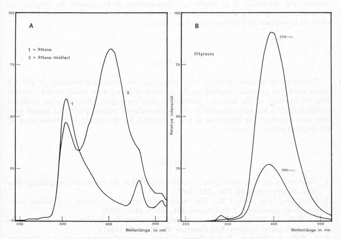
Abb. 5. Emissionsspektren von Ribonuclease und oxidierter Ribonuclease (Anregungswellenlänge: 220 nm: A, und von Dityrosin (Anregungswellenlänge: 220 nm + 280 nm) B, alle in alkalischem Milieu (pH 9,5) aufgenommen.
