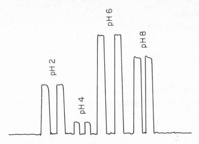
Abb. 1. Cd-Bestimmung von Tabak: Extraktion mit Ammoniumpyrrolidindithiocarbamat/MIBK in Funktion des pH-Wertes.
