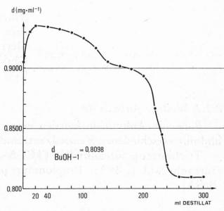
Abb. 5. Dichteabnahme von 3 N HCl-Lösung in n-Butanol bei der Destillation.
