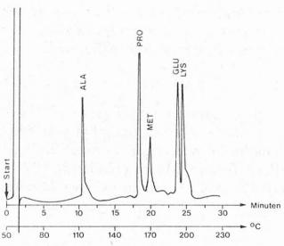
Abb. 2. N-TFA-n-Butylester. Veresterung mit 0,5 N HCl in n-BuOH, wasserfrei.
