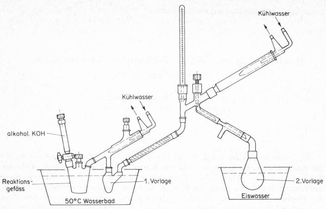
Abb. 1. Apparatur zur Herstellung von Diazomethan
