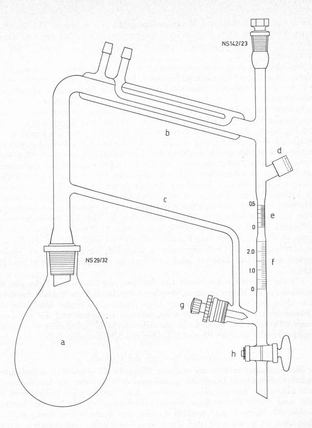
Apparatur zur Isolierung und Bestimmung des ätherischen Oeles. Abb. 1.
