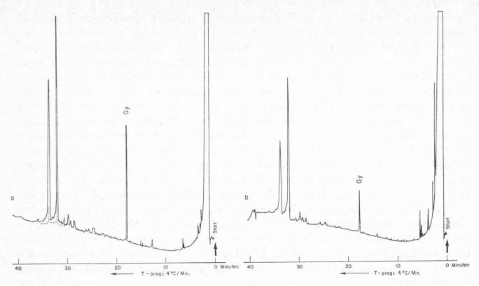
Abb. 2. Gaschromatogrammen an Glasdünnfilmkapillarkolonnen: a = Gyromitrin-Reinsubstanz in Pentan, 1/100 000. b = Pentanextrakt von Trockenlorcheln, Import aus Polen.
