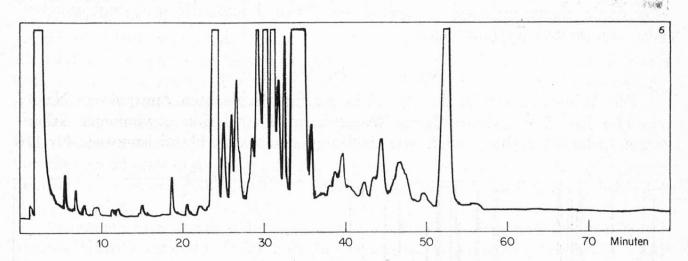
Abb. 6. GC des Wasserdampf-Destillates eines gut aromatischen chinesischen Zimts Cassia Lignea whole (Nr. 3).
