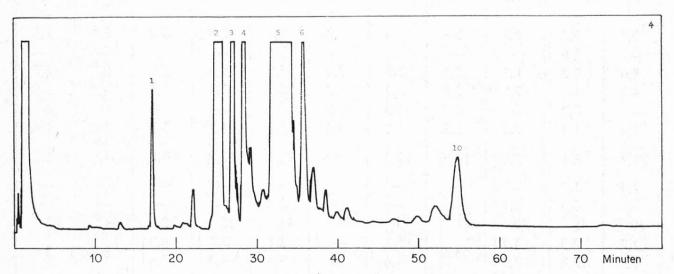
Abb. 4. GC von naturidentischem synthetischem Zimtaroma Typ Cassia (nach Wasserdampf-Destillation).
