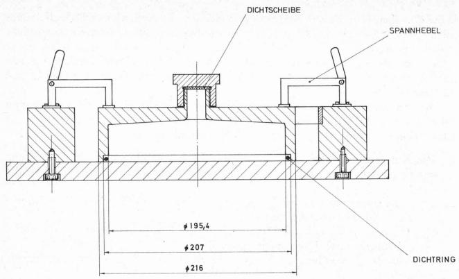
Abb. 2. Querschnitt durch das Extraktionsgerät.
