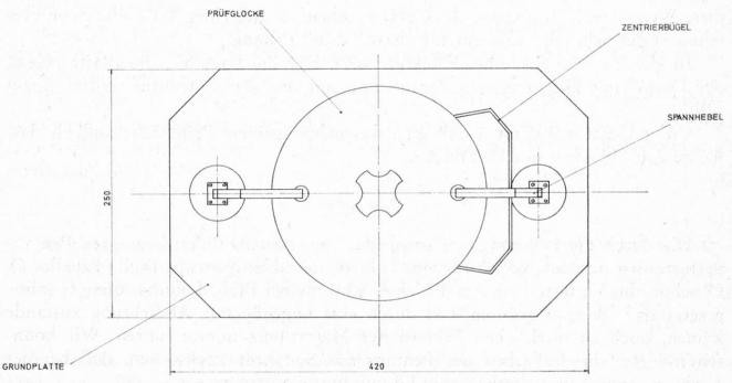
Abb. 1. Grundplatte mit der kreiszylinderförmigen Prüfglocke (Aufsicht).
