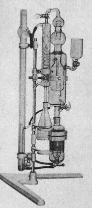
Apparate für die Wasserdampf-Destillation
