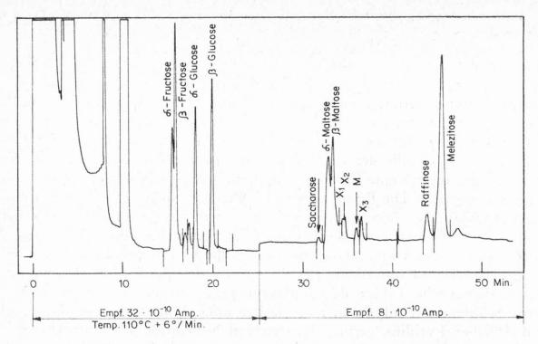
Abb. 2. Gaschromatogramm der Silyläther eines Waldhonigs
