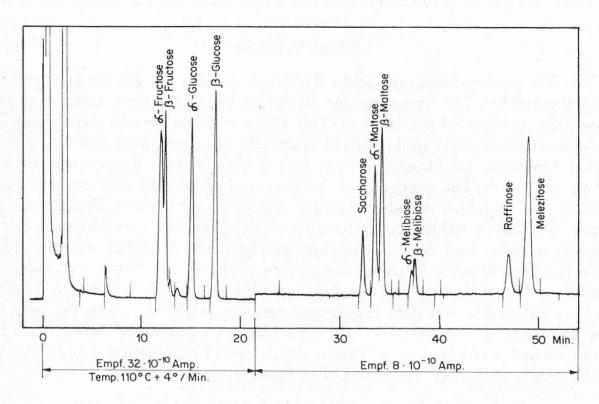
Abb. 1. Gaschromatogramm der Silyläther einer Zucker-Modellmischung (Zusammensetzung siehe Tab. 1).
