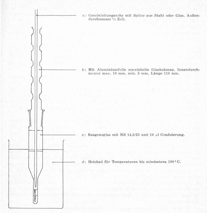
Abb. 1. Versuchsanordnung (Maßstab 1:2)
