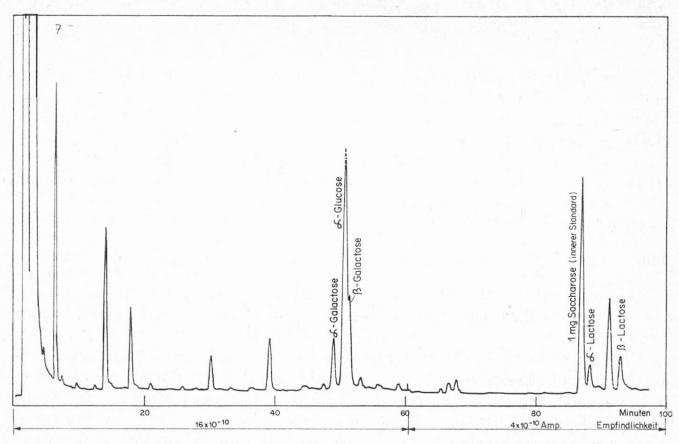
Abb. 7. Essig Nr. 8. GC der Zucker-Silylderivate (1 mg Saccharose wurde als innerer Standard zugesetzt).
