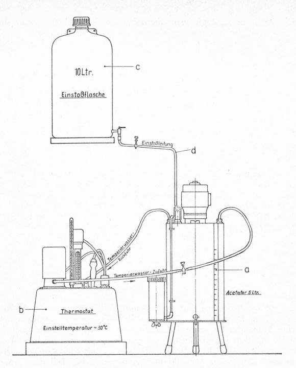
Abb. 1. Labor-Apparatur für die Essigbildung
