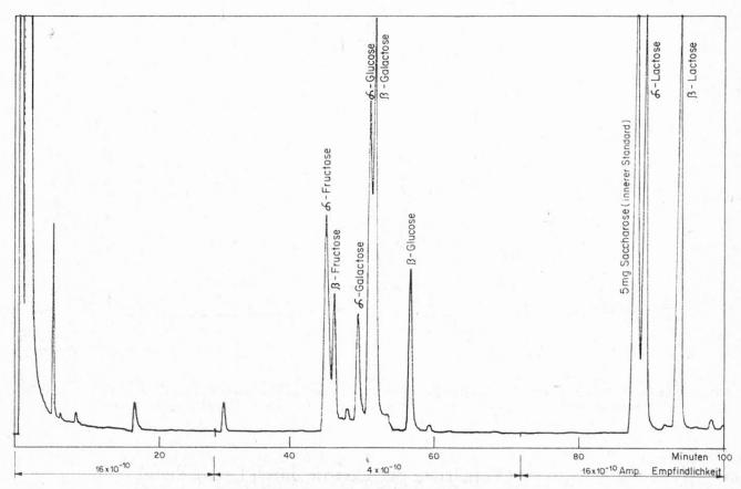
Abb. 4. Rohserum Nr. 4. GC der Zucker-Silylderivate (5 mg Saccharose wurden als innerer Standard zugesetzt).
