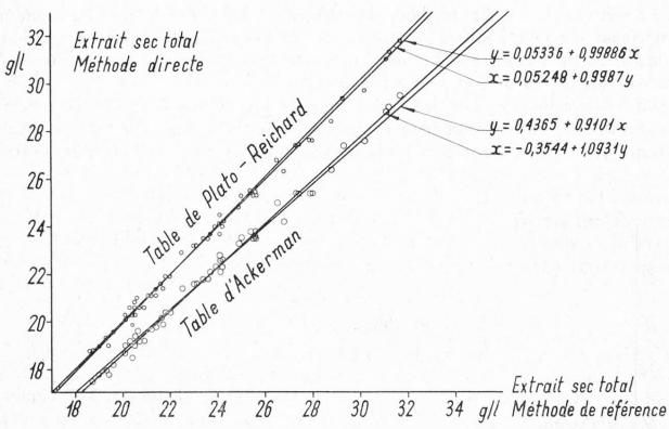
Figure 2. Comparaison des extraits totaux déterminés sur divers vins, par la méthode de référence A3 de l'O.I.V. et la méthode picnométrique directe (M.D.A. 30—05) d'après la tabelle de Plato recalculée par Reichard et d'après celle d'Ackermann. Tracé de la droite de régression des moindres rectanges.
