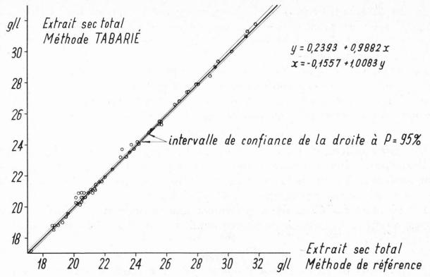
Figure 3. Comparaison des extraits totaux déterminés, sur divers vins, par la méthode de référence A3 de l'O.I.V. et la méthode picnométrique de Tabarie selon la tabelle de Plato. Tracé de la droite de régression des moindres rectangles.
