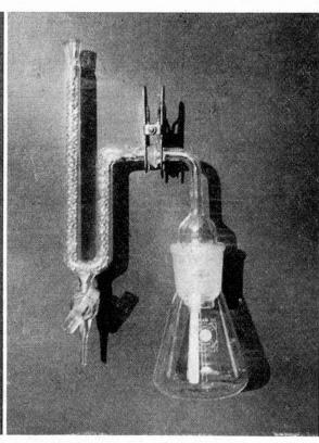
Abbildung 1: Arsin-Generatoren und Absorptionsgefäße, rechts modifizierte Ausführung mit Glashahn.
