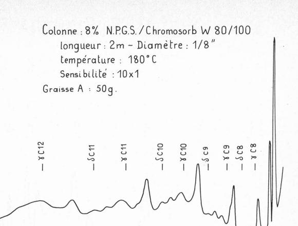
Sur la figure 2 est représenté le chromatogramme correspondant à une graisse et sur la figure 3 le chromatogramme de la même graisse additionnée de  $\gamma$  et  $\delta$  lactones de  $C_8$  à  $C_{12}$  à une concentration de 1 ppm pour chaque lactone.
