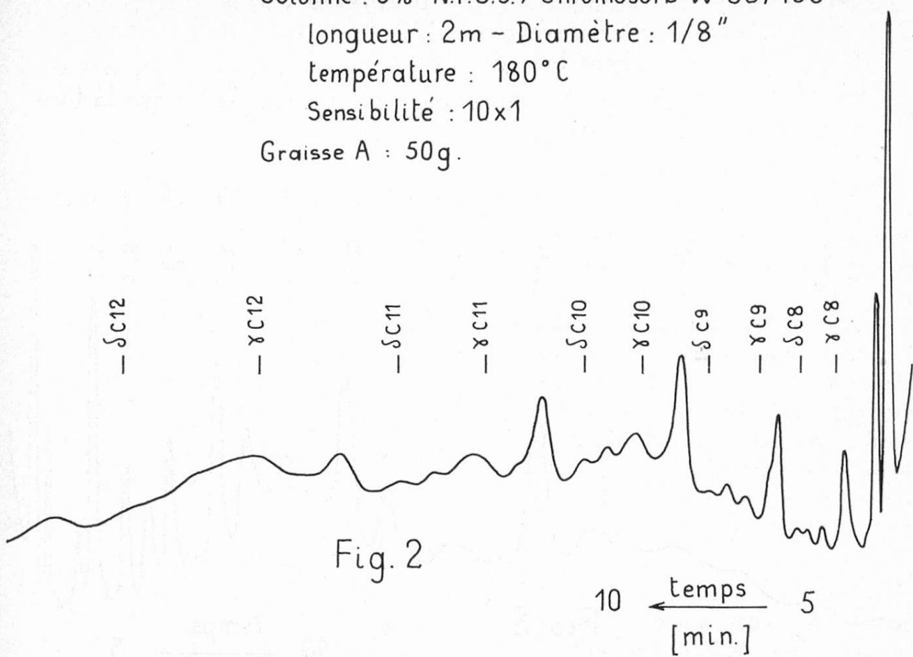
Sur la figure 2 est représenté le chromatogramme correspondant à une graisse et sur la figure 3 le chromatogramme de la même graisse additionnée de  $\gamma$  et  $\delta$  lactones de  $C_8$  à  $C_{12}$  à une concentration de 1 ppm pour chaque lactone.
