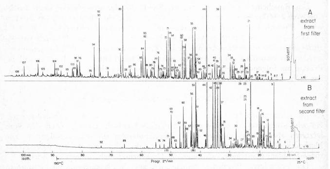
Figur 2. Qualitative Analyse der organischen Luftkomponenten; hohe Filterbelastung (25 m³/25 mg) mit Verlust der leichtflüchtigen Stoffe. Säule: 120 m/0,32 mm, Ucon HB 5100. Substanzen siehe Tabelle 1.
