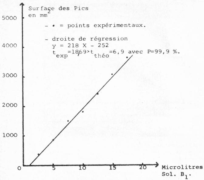
calcul statistique, nous calculons la droite de régression qui sert de base à la détermination de la teneur en aflatoxine d'un extrait inconnu. Nous donnons un exemple d'une telle droite dans la figure 11. L'estimation visuelle de l'intensité des taches peut être utilisée mais elle est très imprécise.
