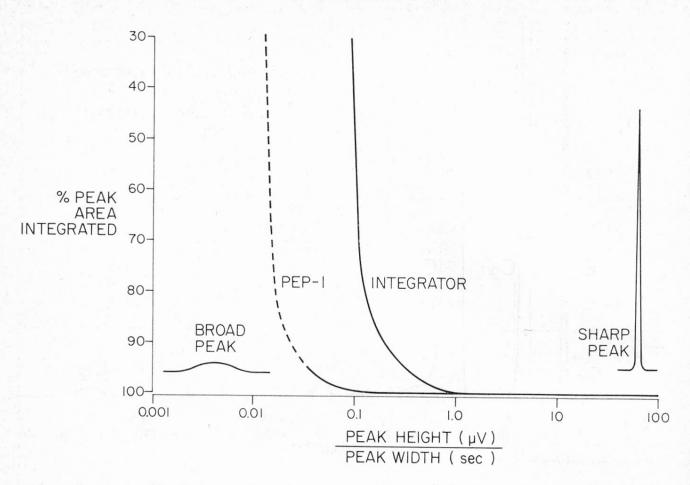
Die Zahlen auf der Ordinate bedeuten Prozente der Peakfläche, die noch erfaßt wurden. Die Genauigkeit der Messungen mit dem Integrator fiel bei 0,1 µV sehr stark ab. Dies war zu erwarten, da die höchsteinstellbare Empfindlichkeit eines Integrators 0,1 µV/sec. beträgt.
