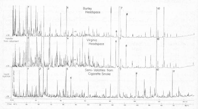
Figur 1. Unter identischen Meßbedingungen analysierte, komplexe Gemische; Probenahme und Uebertragung siehe Text. Säule: Glaskapillare 150 m/0,35 mm, Emulphor 0; 4 ml H<sub>2</sub>/min, FID. 1 Limonen, 2 Furfurol, 3 Pyrrol, 4 Furfurylalkohol, 5 Naphtalin, 6 und 8 Terpenalkohole C<sub>10</sub>H<sub>18</sub>O, 7 Nikotin, 9 Phenol, 10 Neophytadien, 11 Indol. Weitere Identifikationen siehe (3).
