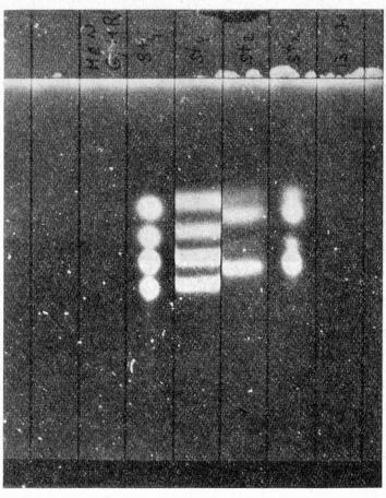
— Standard US contenant  $(B_1+B_2+G_1+G_2)$ , dépôt sous la forme d'une tache.
