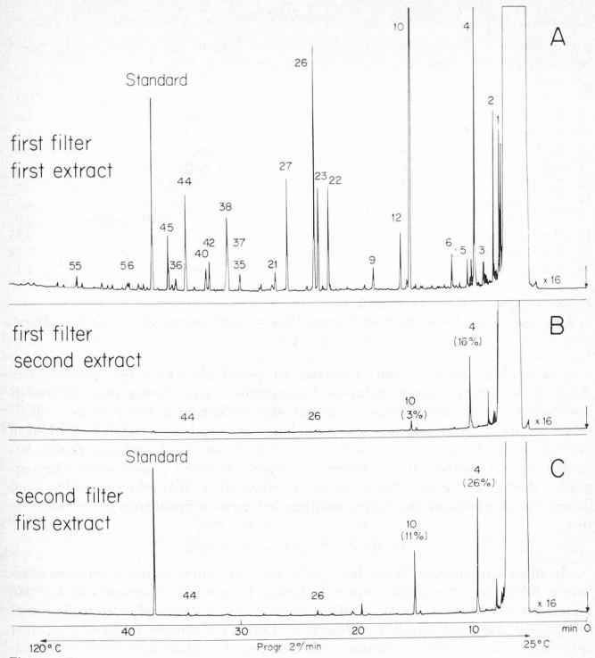
Figur 3. Quantitative Analyse der leichtflüchtigen organischen Luftkomponenten; niedrige Filterbelastung (250 1/25 mg.) Säule: 80 m/0,33 mm Ucon LB 550. Substanzen siehe Tabelle 1. Quant. Auswertung siehe Tabelle 2.
