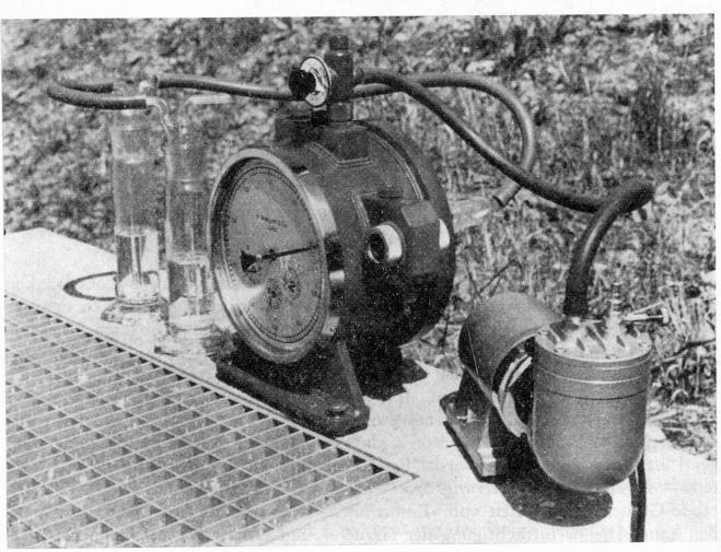
Zwecks Ueberprüfung dieses Analysenverfahrens haben wir Kresolflaschen (enger Flaschenhals) geöffnet im Laboratorium im Abstand von 20 cm, und 80 cm vom Saugstutzen entfernt aufgestellt; anschließend wurden jeweils 1000 l Luft angesogen. Die erzielte Kresolkonzentration lag bei 291 bzw. bei 189 µg/m³. Die untere Erfassungsgrenze liegt bei 2 µg/m³ (Meßwerte von sauberer Außenluft).
