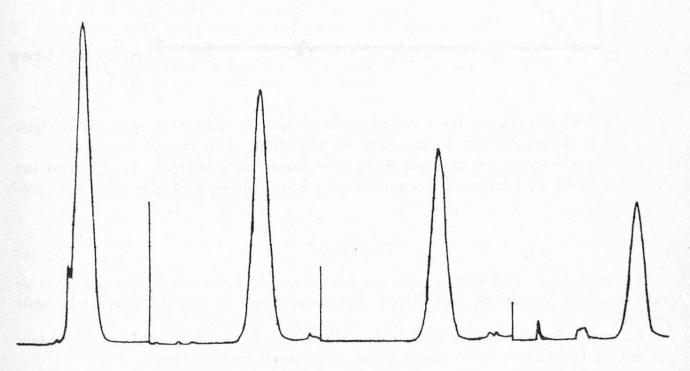
Grâce à cet enregistrement, nous pouvons tracer une courbe d'étalonnage reliant la surface des pics à la concentration en aflatoxine B<sub>1</sub>. Avec le
