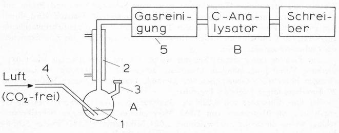
Abbildung 1: Meßapparatur
