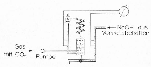
Abbildung 2: Meßprinzip des CO2-Analysators
