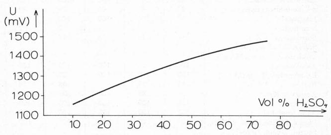
Abbildung 4: Abhängigkeit des Normaloxydationspotentials einer 0,04 normalen Kaliumdichromatlösung von der Schwefelsäurekonzentration bei 20 °C.
