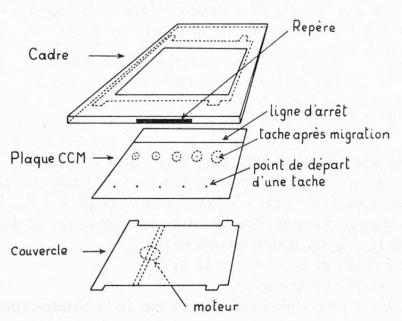
Figure 5 Fixation de la plaque CCM
