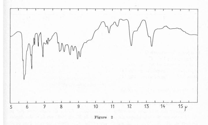
Attendre 1 minute. Défaire le dispositif et placer la pastille dans le spectrophotomètre. Enregistrer le spectre. Sur la figure 3 nous avons reproduit le spectre d'un échantillon de coumarine et sur la figure 2 celui du produit isolé. L'examen de ces spectres montre que le produit isolé est bien de la coumarine.
