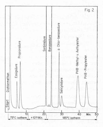
Gas-chromatographische Trennung verschiedener Konservierungsmittel. Versuchsbedingungen: 5 % DEGS + 1 % H<sub>3</sub>PO<sub>4</sub> auf Aeropack-30 80/1000 mesh. 2 m × ½ (3,2 mm  $\phi$  Stahlsäule). Trägergas N<sub>2</sub>, 20 ml/min. Einspritzmenge 2  $\mu$ l FID Empfindlichkeit 8. 10-10 Amp. Detektor- und Injektortemp. 220 °C, Papiervorschub 10 inch/h. Temperaturprogramm siehe Figur.
