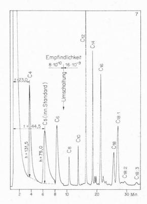
Figur 7: GC für Handauswertung. 65 °C isotherm bis C<sub>6</sub> (Umschaltung) Programm + 8 °/Min. → 190 °C.
