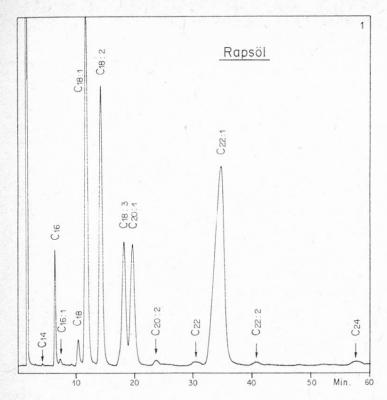
Figur 1: GC der Fettsäuren-methylester von Rapsöl; isotherm 190°C.
