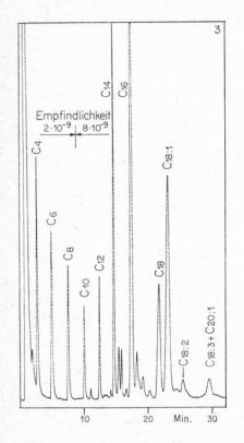
Figur 3: Butterfett ohne inneren Standard. Temperaturprogramm 60°C + 8/Min.
