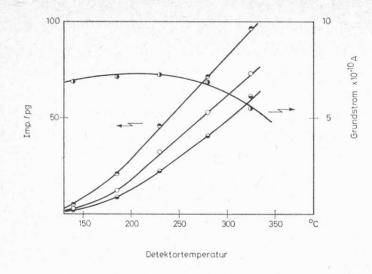
Abbildung 3. Einfluß der Detektortemperatur auf die Detektorempfindlichkeit
