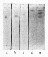
Abbildung 8. Trennung der isomeren Trichlorbenzole von Hexachlorbenzol 1-dimensional mit n-Pentan, in Klammern Rf-Werte: (a) 1,2,3-TCB (0,76), (b) 1,2,4-TCB (0,84), (c) HCB (0,86), (d) 1,3,5-TCB (092), (e) Mischung (a—d).
