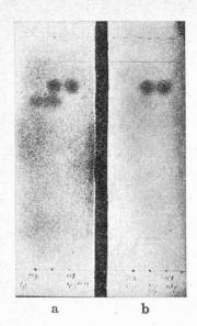
Abbildung 6. Einfluß der Feuchtigkeit im Fließmittel auf die Erfaßbarkeit von 1,2,4-TCB neben Hexachlorbenzol (125 ng 1,2,4-TCB, 40 ng HCB)
