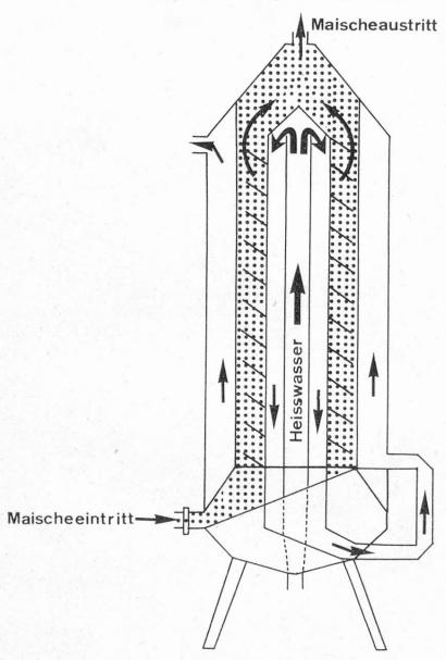
Abbildung 4 Wiegand-Maischeerwärmer im Schnitt
