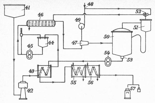
Abbildung 11. Schema des Uperisations-Verfahrens. Fig. 7 des schweiz. Patentes 284 061
