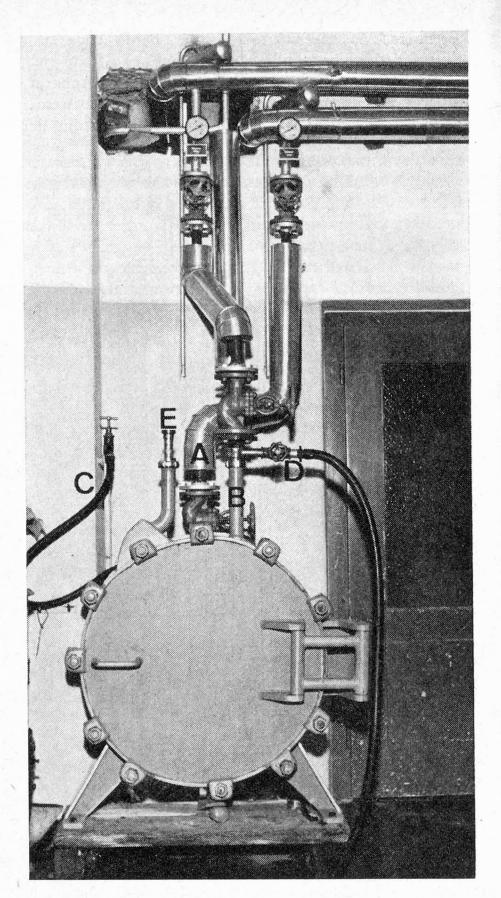
Abbildung 5 Rosenblads-Maischeerwärmer-Kühler in geschlossenem Zustand. Der Maischerücklauf und der Heißwasser-Vorlauf befin-den sich auf der hinteren Seite des Gerätes und sind auf dem Bild nicht sichtbar.
