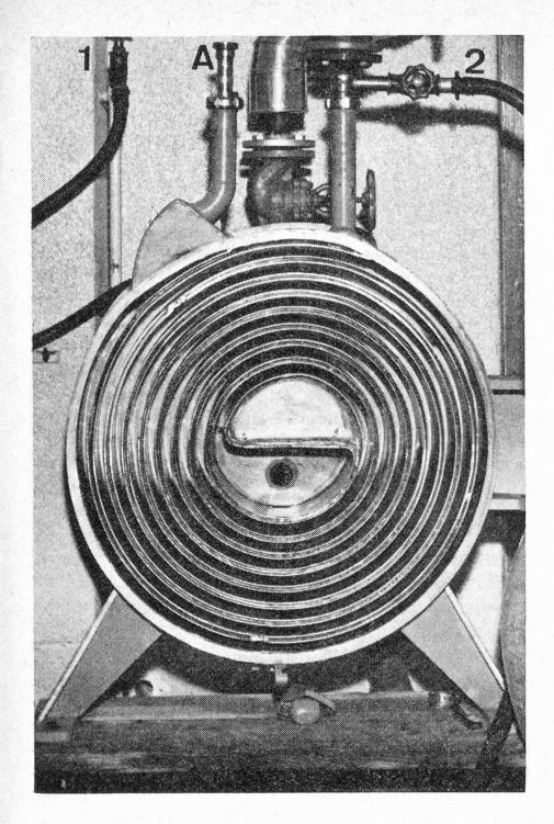
Abbildung 6 Rosenblads-Maischewärmer-Kühler in geöffnetem Zustand. Der Maischeteil ist in geöffnetem Zustand frei zugänglich, ohne daß Maischeoder Wasser-Anschlüsse gelöst werden müssen. Gut sichtbar sind auf diesem Bild der Kühlwasser-Vorund Nachlauf (1+2) sowie der Maischeeinlauf A.
