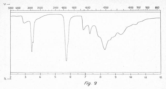
— Ester d'acide diacétyltartrique et de monoglycéride Spectre enregistré en solution dans le CCl<sub>4</sub>
