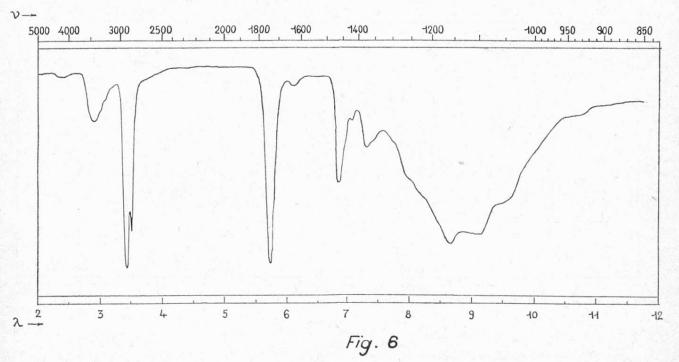
— Fraction II B du monoglycéride lactylé Spectre enregistré en solution dans le CCl<sub>4</sub>
