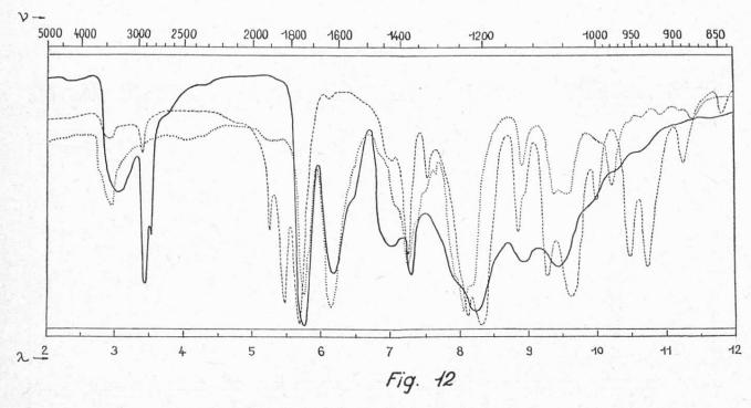
Fraction IV de l'ester d'acide diacétyltartrique et de monoglycéride Spectre enregistré en solution dans le CCl<sub>4</sub>
